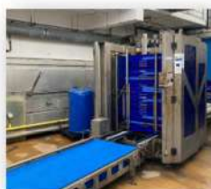
Automatisation lavage bac La Turballe
